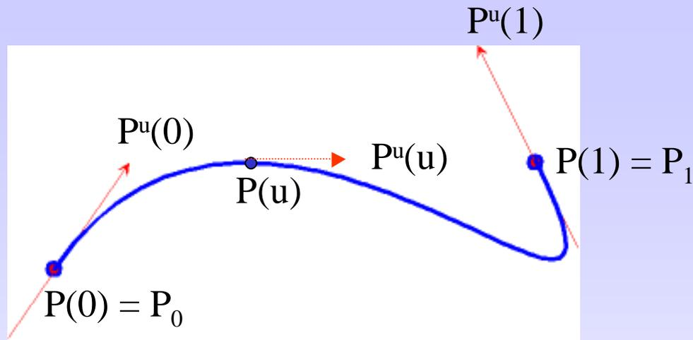
La forme algébrique d'une courbe de Hermite est donnée par 3 polynômes de degré 3:
