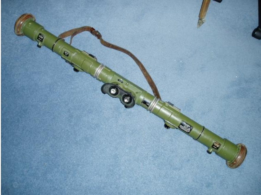
Télémètre Allemand Entfernungsmeßgerät-1m-R-36 Tir anti-aérien Baseline b = 1 \text{ m}
