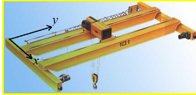
FIGURE 2 – Exemple d'un pont roulant, utilisé pour déplacer des charges dans un espace de travail ouvert dans une usine. Les déplacements en x et en y sont parfaitement découplés.
